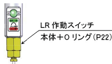
図 3-3-2: LR 作動スイッチの取付
