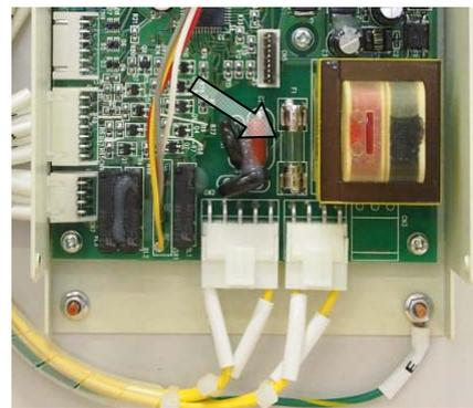
(1) 制御盤の扉裏面のコントローラー底面のコネクタ(2個)を抜き、M3ねじ4本をはずしてください。
